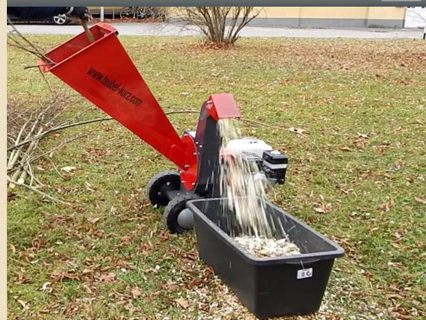
Der Häcksler mit einer beeindruckenden Leistung bis 6 cm Holz-Stammdurchmesser. Ein Messer schneidet Äste in Hackgut-Qualität mit einer Größe von 3–4 cm. Der aggressive Einzug und ein hoher Auswurfkamin sorgen für wirtschaftliches Arbeiten im Garten. Das Häckselgut wird direkt auf den Kompost oder in die Scheibtruhe ausgeworfen. Diese Geräte sind auch mit Elektroantrieb 230V oder 400V verfügbar.
