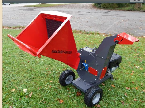
Der Stärkste unter den Profi-Häckslern verarbeitet Äste und Strauchmaterial bis zu 10 cm Durchmesser. Beeindruckend ist der aggressive Einzug, der schnelles und kontinuierliches Arbeiten ermöglicht. Mit einer Spurweite von 76 cm sind auch schwer zugängliche Gärten noch erreichbar. Der Trichter kann aufgeklappt werden. Für den Messerwechsel und die Reinigung sind zusätzliche Öffnungsdeckel vorgesehen.
