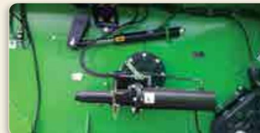
Mit dem hydraulischen Wellenzieher können die Schlegel ganz einfach gewechselt werden!
