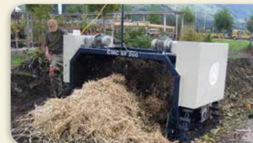
Die SF 200 überzeugt durch optimale Mischfähigkeit, einfache Bedienung, minimalen Platzbedarf. Minimalste Lärmentwicklung durch hochwertige Elektroantriebe.
