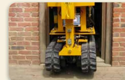
Die P38 und P56 kann durch die schmale Bauweise und das hydraulisch verstellbare Raupenfahrwerk auch durch Türöffnungen fahren!
