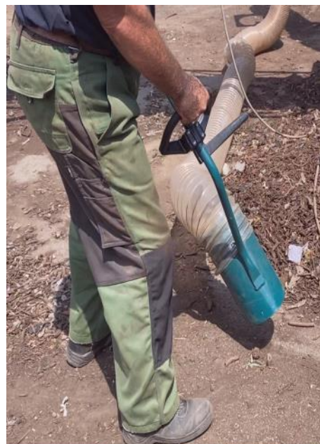
Handsaugdüse mit 10m Schlauch
