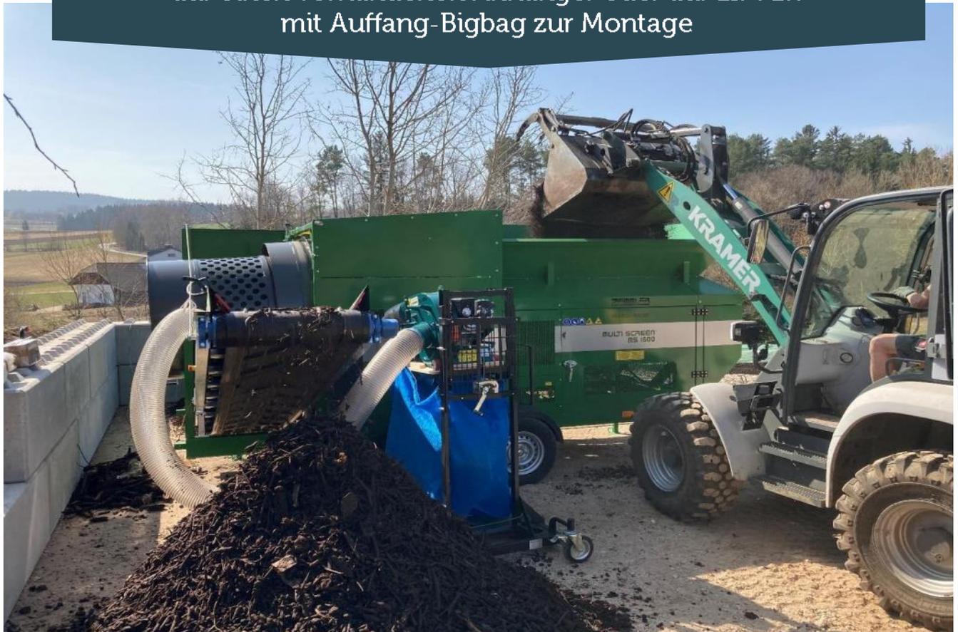
Der MINI VL 300 ist vielseitig einsetzbar: Einfach zu einer kleinen Siebmaschine dazu stellen und Plastikteile absaugen, oder mit dem Fahrgestell am Platz herum fahren und mit dem 10 m langen Saugschlauch am Boden liegende Plastikteile aufsaugen, Das Gebläse wird mit einem Kohler-Benzin-7 PS Motor angetrieben und kann auch direkt an die Bordwand eines Anhängers eingehängt werden.
