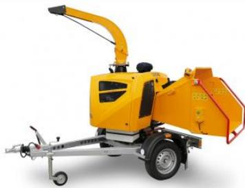
Leistungsstarker Buschholzhäcksler mit Benzinmotor auf gebremstem Fahrgestell montiert (38 HP)
