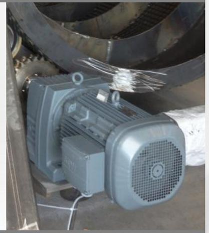
Robuste Antriebseinheiten treiben die Trommeln direkt an!
